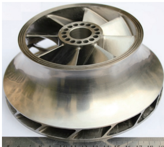
(b) 大小叶片闭式整体叶轮
